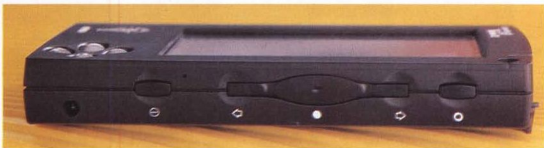
Sul lato destro troviamo il tasto "Escape", quello basculante per lo scroll con al centro l'"Action" cioè l'"Enter", l'interruttore di accensione e la presa per l'alimentatore.
